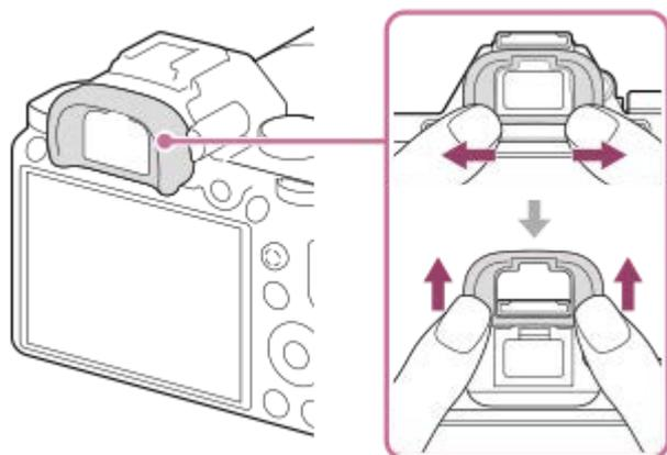
Retirez l'oculaire de visée lorsque vous fixez un viseur en angle (vendu séparément). De plus, sélectionnez MENU → 2 (Réglages de prise de vue2) → [FINDER/MONITOR], puis basculez sur [Viseur(manuel)] ou [Écran(manuel)].
